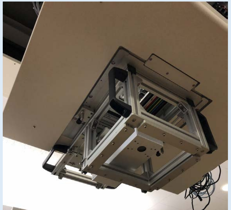
【図 2】重粒子線の出射口に取り付けられた位置決め用の X 線装置。重粒子線の照射直前に標的位置を正確に合わせるために使われる。
